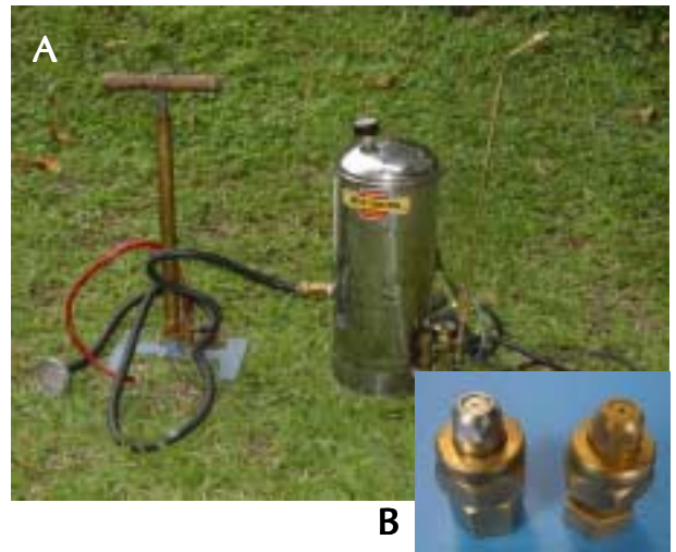
Figura 4. (a) Aspersora Triunfo® 40-100-10, de PPR. (b) Boquillas TX-2 y TX-3 Spraying System Co. de cono hueco.
