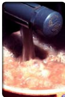
Figura 14. Entrada de las aguas mieles a la trampa de pulpa.
