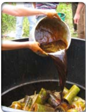
Figura 38. Adición de la fuente de carbono durante la inoculación de un reactor metanogénico.
