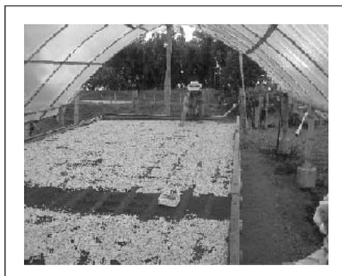
**Figura 2.** Ilustración del proceso de secado de café pergamino en secadores solares y ubicación de la canastilla.
