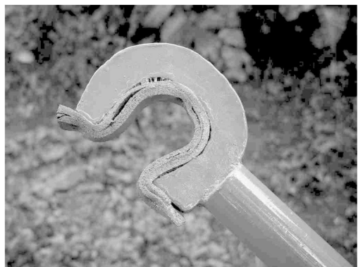
Figura 6. Gancho en forma de C, con caucho espumado en su interior, colocado en cada extremo de la estructura telescópica para permitir un rápido acople al tronco del árbol sin causar lesiones en la corteza.
