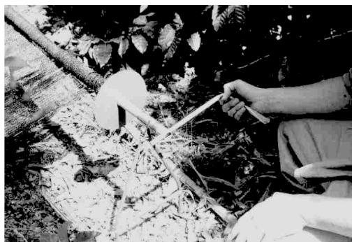
Figura 4. Manivela utilizada en el enrollado de la malla y recolección del café.
