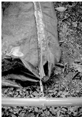
Figura 7. Fijación de la malla a la estructura telescópica. Detalles de la malla de fabricación italiana utilizada, de la cremallera colocada en un costado para permitir su ubicación en el cable y del accesorio empleado para templar el cable.
